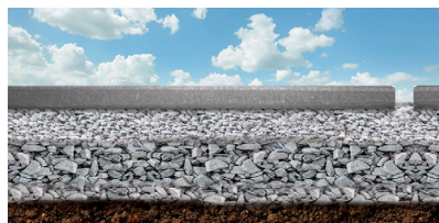
— gres Solid 2.0 — drobny żwirek (cząstki 4-8 mm) — warstwa grubego żwiru (cząstki 16-35mm) — ubity grunt
